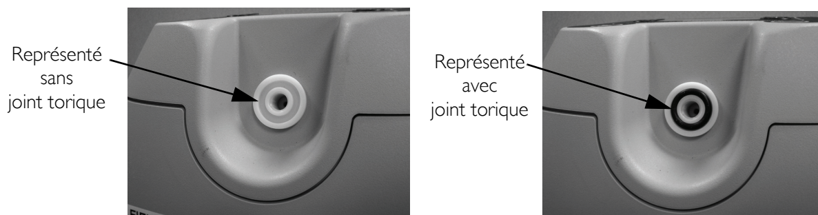
FIGURE 2.3 Remplacement du filtre HEPA de sortie patient
