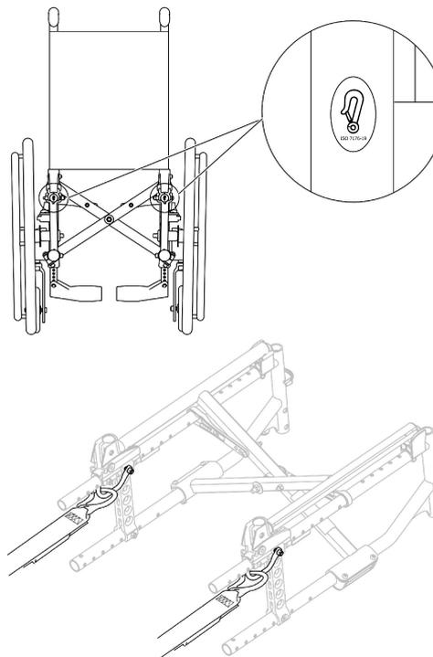
1. Fixez les mousquetons aux anneaux orange, comme indiqué sur les deux figures ci-dessus (cf. emplacement des étiquettes de fixation).
