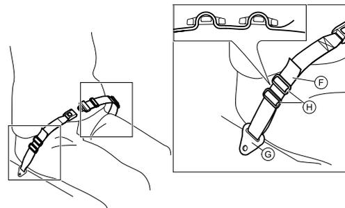
1. Faites passer la boucle ④ dans la fixation du fauteuil ⑤ puis dans les DEUX boucles en plastique ⑥.
