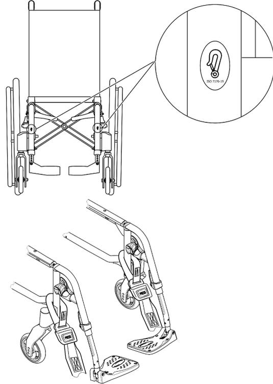
1. Fixez les sangles avant au-dessus des supports de roues avant, comme indiqué sur la figure ci-dessus (cf. emplacement des étiquettes de fixation).
