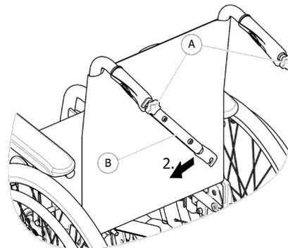
1. Desserrez légèrement les deux vis à main **A**, tirez sur le renfort de dossier **B** et faites-le pivoter vers le bas le long du dossier.
