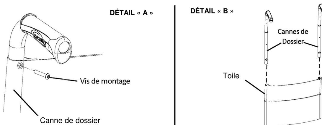
FIGURE 4.3 Démontage/installation de la toile de dossier standard
