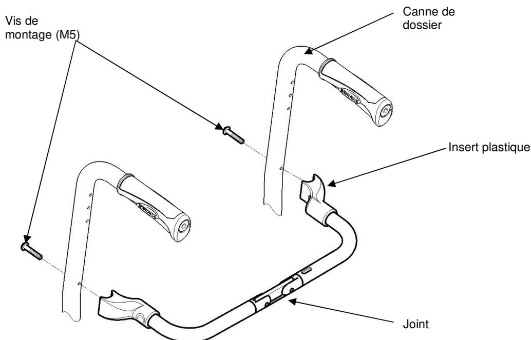
FIGURE 4.13 Installation/démontage du tendeur de dossier pliable
