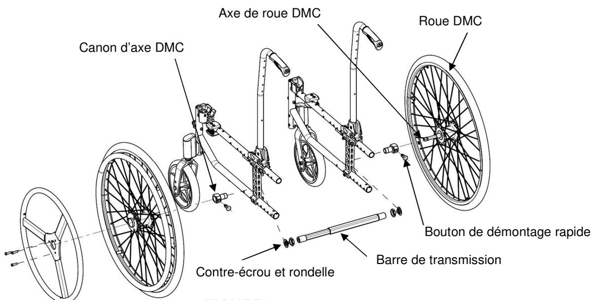
**FIGURE 8.1** Installation de la double main courante
