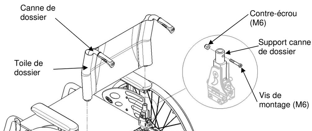
**FIGURE 4.1 B** Démontage des cannes de dossier réglables
