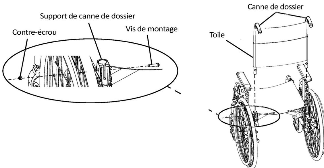
**FIGURE 4.1 A** Démontage des cannes de dossier standard
