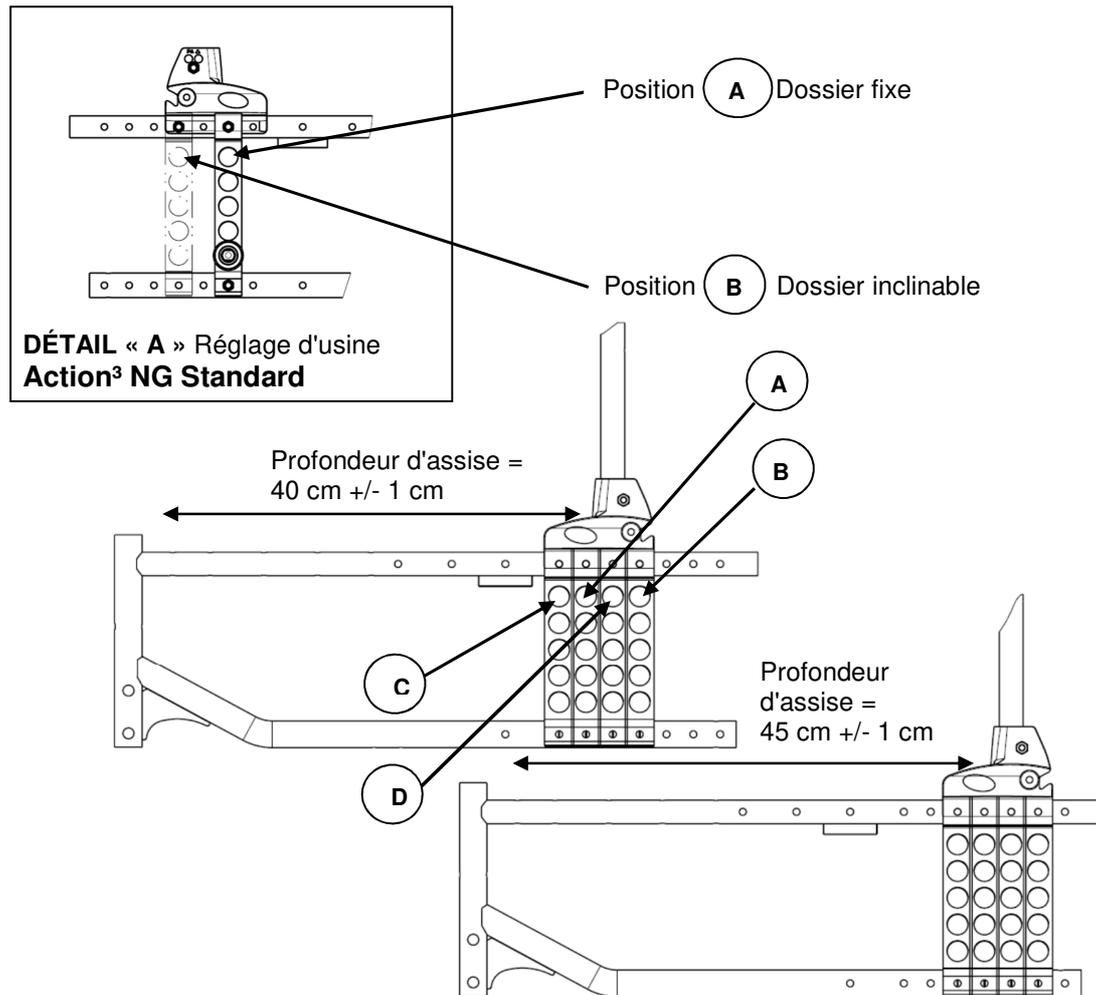
**FIGURE 5.6** 4 positions possibles de la platine de roue
