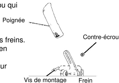
**FIGURE 7.3** Remplacement de la poignée de frein
