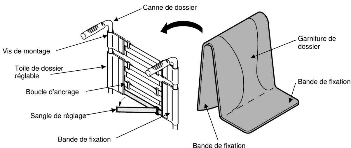
**FIGURE 4.4** Installation/remplacement de la toile de dossier réglable
