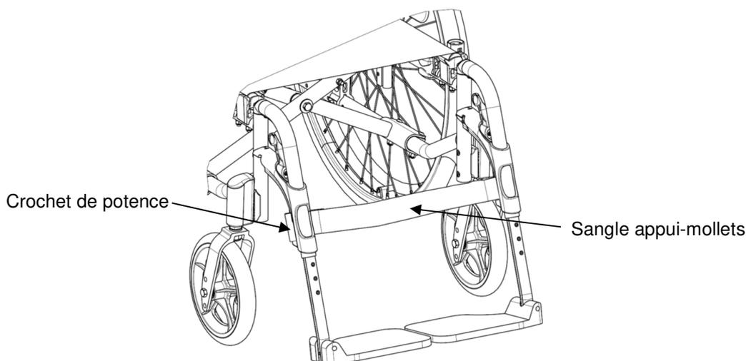
**FIGURE 2.3** Installation de la sangle appui-mollets
