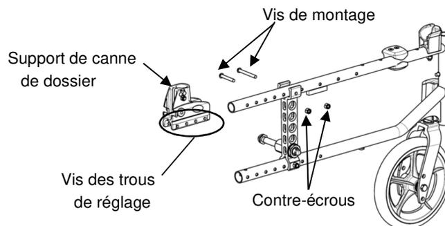
**FIGURE 4.10** Démontage/installation/réglage du support de canne de dossier
