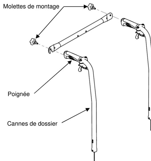
**FIGURE 4.12** Installation/démontage du tendeur de dossier standard
