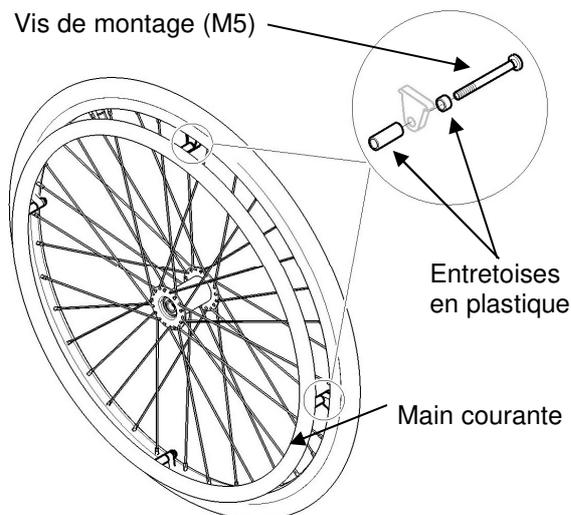
FIGURE 5.4 Remplacement des mains courantes
