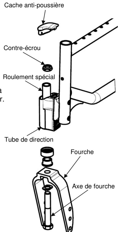
**FIGURE 5.8** Réglage de la rotation des fourches
