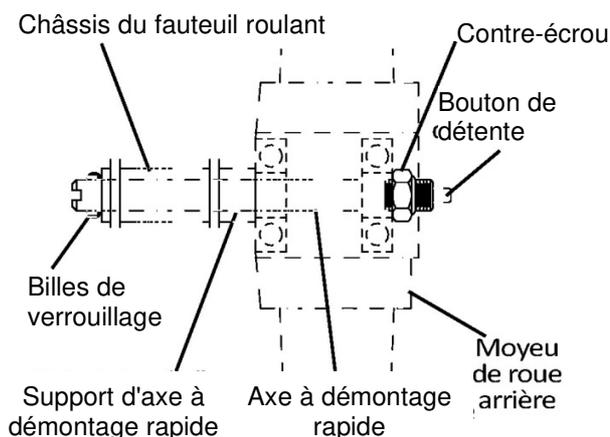
FIGURE 5.3 Réglage des axes à démontage rapide
