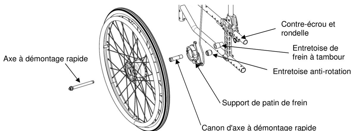
**FIGURE 7.4** Installation des freins à tambour
