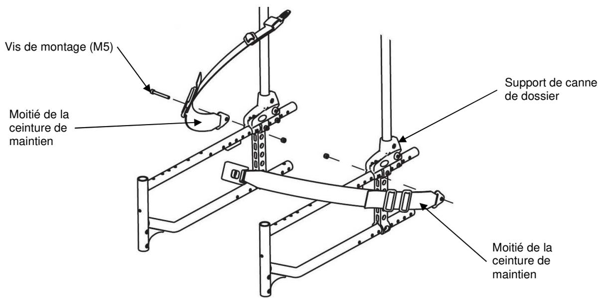
**FIGURE 4.11** Installation/démontage de la ceinture de maintien
