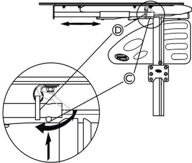
2. Appuyez sur le bouton poussoir **C** et insérez la bague **D** sur le tube **A**.
