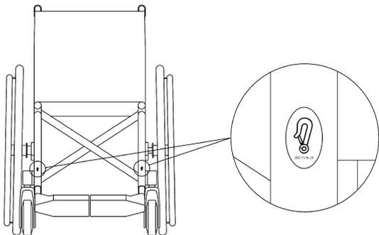
1. Fixez les sangles avant au-dessus des supports de roulettes avant, comme indiqué sur la figure ci-dessus (cf. emplacement des étiquettes de fixation).
