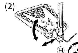
1. Desserrez la vis de fixation ⑥ ou ⑧ à l'aide d'une clé Allen de 5 mm.
