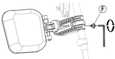
Le coussin appui-mollets offre quatre options de réglage de la profondeur :
