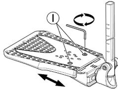
1. Desserrez les deux vis de fixation ① à l'aide d'une clé Allen de 5 mm.
