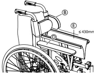
**i** Les coussins de positionnement latéral (B) doivent être placés au-dessus de la manchette d'accoudoir (D) pour que le pliage du fauteuil roulant soit possible.
