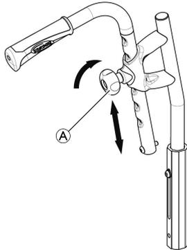
1. Pour régler la hauteur des poignées de poussée, desserrez la molette (A), poussez la poignée dans la position voulue puis resserrez la molette.
