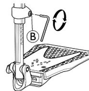
1. Desserrez la vis de fixation ⑥ à l'aide d'une clé Allen de 5 mm.
