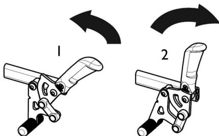
1. Pour actionner le frein, tirez le levier de frein vers l'arrière avec les doigts aussi loin que possible.
