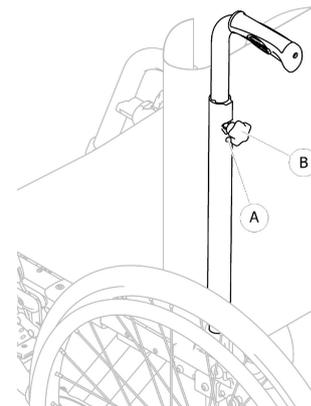
1. Pour régler la hauteur des poignées de poussée, desserrez la molette (A), poussez la poignée dans la position voulue puis resserrez la molette.
