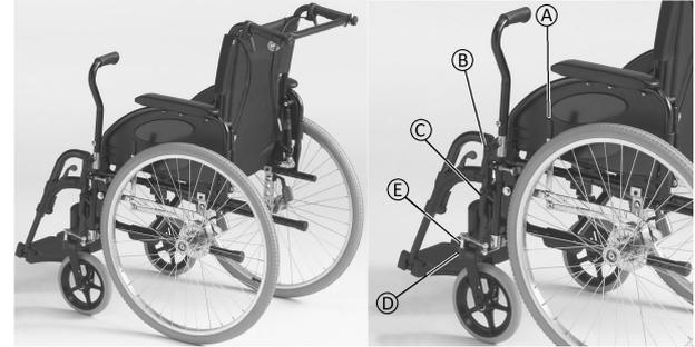
Le réglage s'effectue en déplaçant le manchon des liens de transmission sur le levier de commande.
