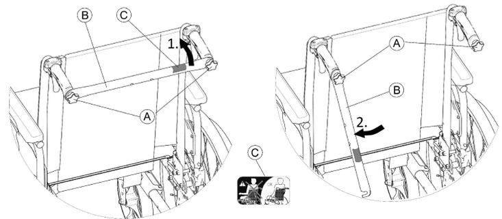
1. Desserrez légèrement les deux vis à molette (A), tirez sur le renfort de dossier (B) et faites-le pivoter vers le bas le long du dossier (à gauche ou à droite).
