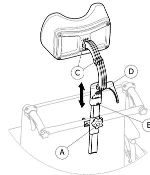
1. Desserrez la vis dans le bloc d'arrêt ②.
