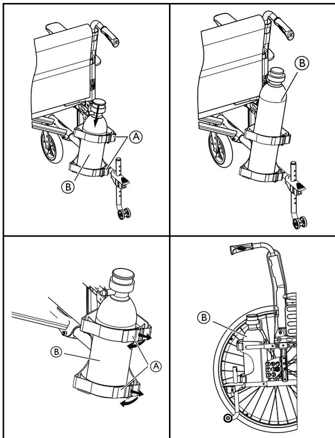
1. Tirez sur les bandes autoagrippantes (A) à l'arrière du support O<sup>2</sup> pour les desserrer.
