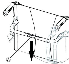
1. Déverrouillez le tendeur pliable en poussant le joint (A) légèrement vers le bas.
