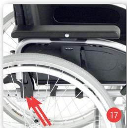
Commencez par retirer la fixation de la partie latérale et du dossier, en desserrant les vis de fixation (voir fig. 17).
