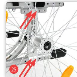
Grâce à l'allongement de l'empattement, la stabilité et l'équilibre du fauteuil roulant sont améliorés. Une diminution de l'empattement permet en revanche une meilleure manoeuvrabilité. Une diminution de l'empattement n'est recommandable que pour des utilisateurs expérimentés.
